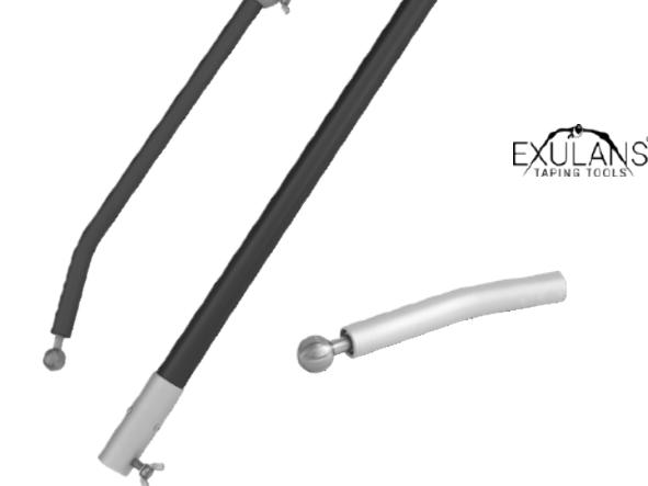
Cabo extensível universal em alumínio anodizado indicado para usar com os rolos, terminadores de canto, alimentador de canto, caixa tapa parafusos e cabeças aplicadoras de pasta. Diferentes pontos de travamento para ajustar o comprimento. Cabo antiderrapante em borracha.
