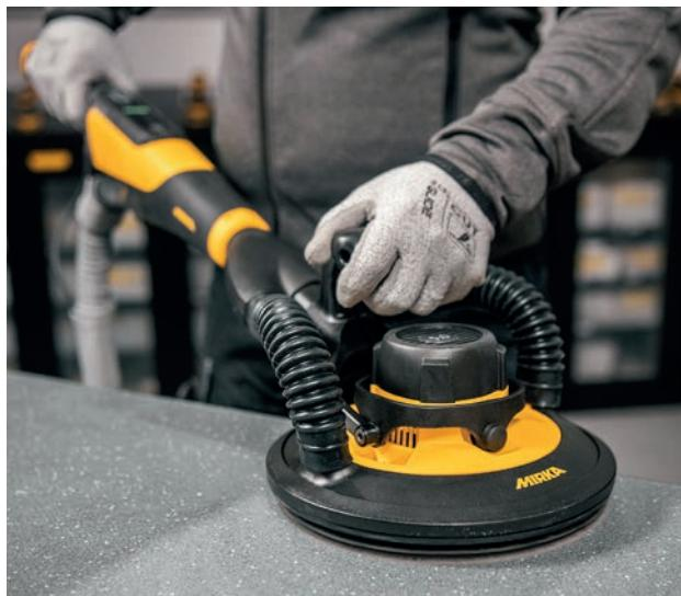
A bem equilibrada LEROS-S, com pegas ergonómicas de duas mãos, oferece-te total controlo e manobrabilidade durante o processo de lixagem.
