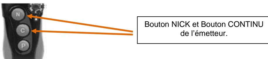
4. Maintenez le bouton Nick et le bouton Continu situé sur le devant de l'émetteur appuyé simultanément pendant 3 secondes, ou jusqu'à ce que le voyant LED du collier-récepteur clignote plus lentement.
