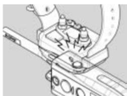
3. Placer le point rouge magnétique situé au dos de l'émetteur sur celui situé sur le collier-récepteur. Maintenez-les ainsi pendant 5 secondes. Lorsque le voyant LED situé sur le collier-récepteur commence à clignoter rapidement, séparer les deux points rouges.
